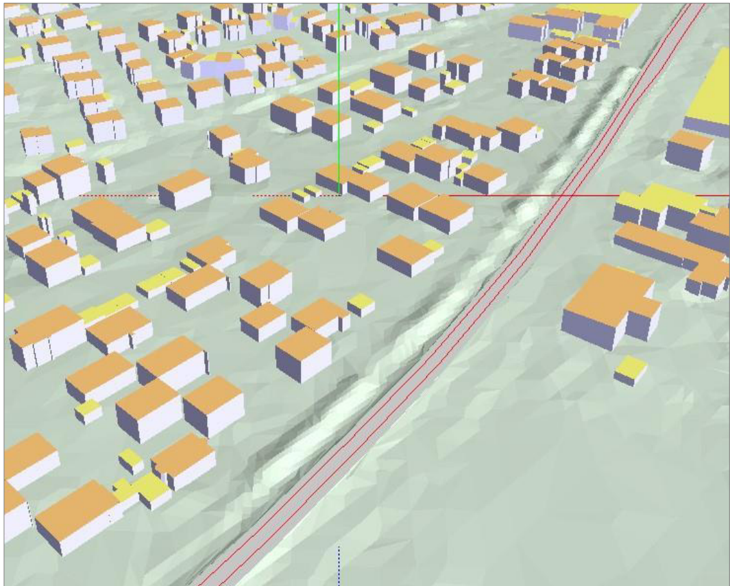
Abbildung 7: Lärmschutzwall zw. Bebauung Brühlstraße und L 384, 3D-Darstellung
